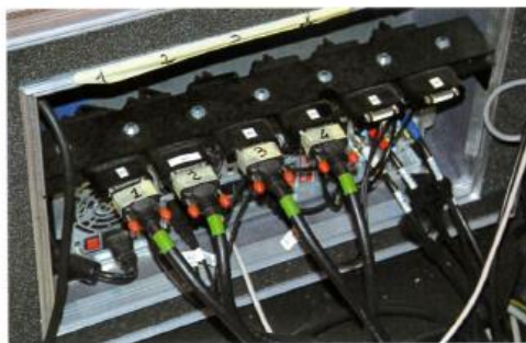
Il media server 7thsense. Al momento, per la trasmissione, vengono utilizzate solo 4 delle 6 uscite video DVI, due per ogni Ledwall.
